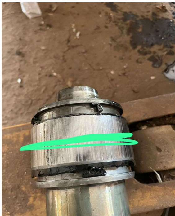
Cilindro hidráulico: diagnóstico de desgaste e ranhuras
