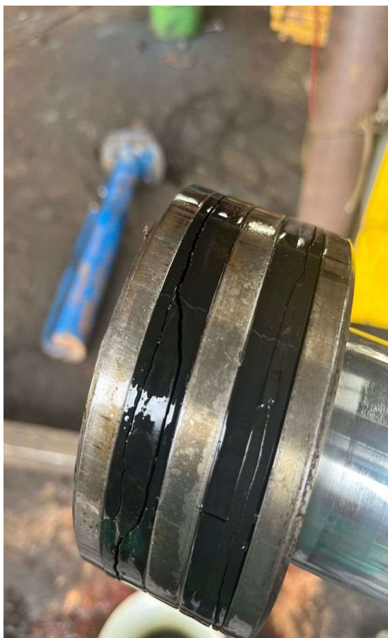
Êmbolo/pistão hidráulico em recuperação
