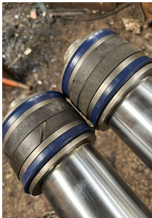
Haste e reparos do êmbolo durante a intervenção
