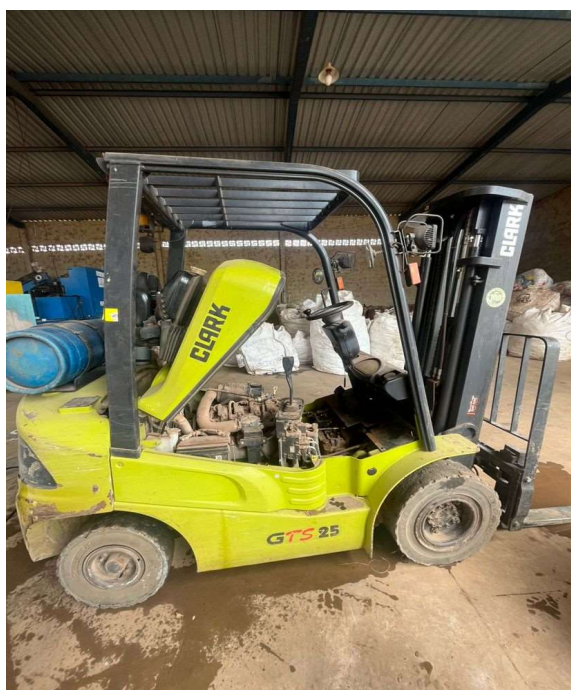
Empilhadeira Clark GTS25: revisão do motor
