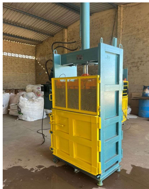
Prensas recuperadas e repintadas, prontas para operação
